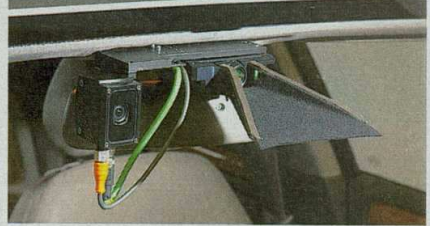
In einem Audi A8-Versuchsfahrzeug sitzen die zwei Kameras unter dem vorderen Dachhimmel. Ein Infrarot-Lichtband im Grill ermöglicht auch Aufnahmen bei Nacht
